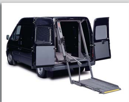
Manuelles Einklappen der Plattform erfordert nur geringen Kraftaufwand.
