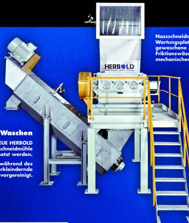
Nassschneidmühle (Waschmühle) mit Wartungsplattform. Das zerkleinerte und vorgewaschene Material fällt in einen Friktionswäscher und wird danach in einen mechanischen Trockner gefördert
